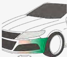
Application de la couche de finition/ du vernis Deklaklaag/ Blanke laklaag
